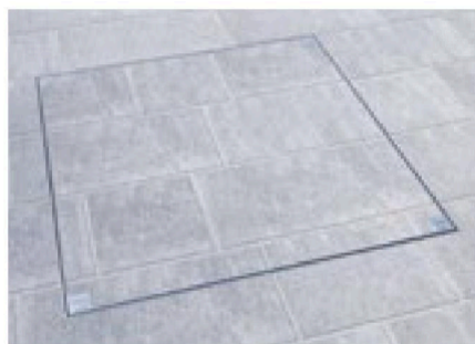
Čtvercový šachtový poklop (ocel), lze individuálně vyplnit, třída B125, 50 × 50 cm
